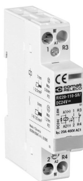
Il contattore ferroviario RIC20-110-SR/DC24V svolge funzioni di commutazione essenziali nella locomotiva DE 18 e garantisce una commutazione affidabile dei carichi in corrente continua anche in condizioni operative gravose.
