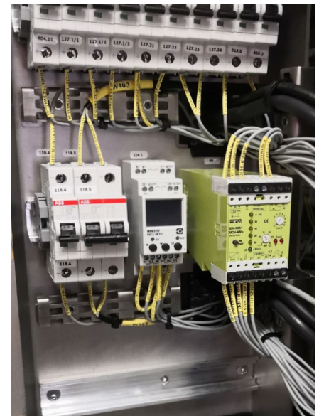
Multifunktions-Überwachungsrelais sichern die Stromversorgung und schützen die Fahrzeugelektronik.
