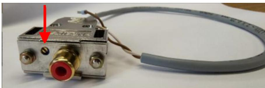
Abbildung 2: Ersteinstellung Potentiometer
